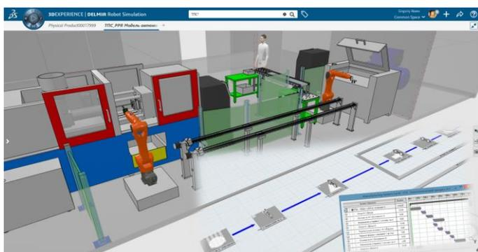
Рис. 4. Модель производственной ячейки и технологического процесса, представленная с помощью диаграммы Ганта (как показано в DELMIA 3DEXPERIENCE)
